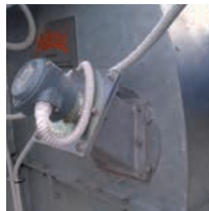
ENG. Anti-choke on head FRA. Anti-engorgement sur tête ITA. Antintasamento sulla testa
