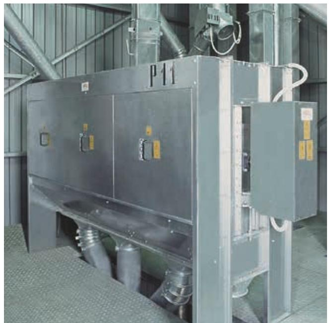
*Les nettoyeurs à tambour PT sont utilisés pendant la phase de pré-nettoyage pour séparer les plus grosses impuretés des céréales. Ils sont conformes à la directive 2006/42/CE et sont fournis pour l'utilisation en atmosphère potentiellement explosibles conformément à la directive 94/9/CE.*
